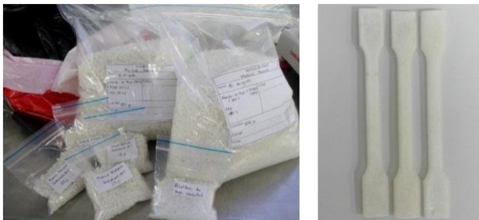
Figura 5: Productos finales pellets y probetas tipo corbatín
